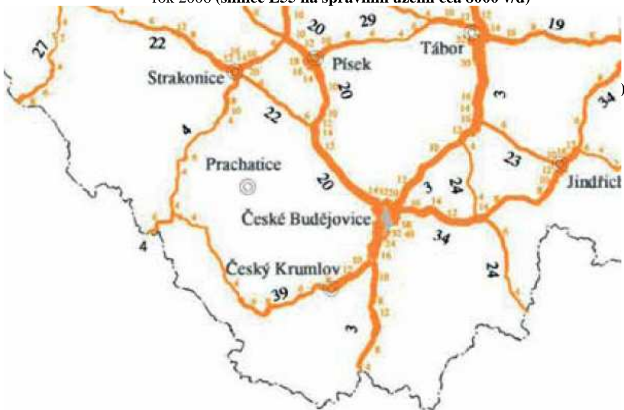
Mapa č. 6 Hodnocení intenzit provozu (v tisících vozidel/den) na pozemních komunikacích za rok 2006 (silnice E55 na správním území cca 8000 v/d)
